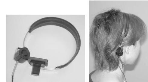
図 1. 骨導超音波補聴器
