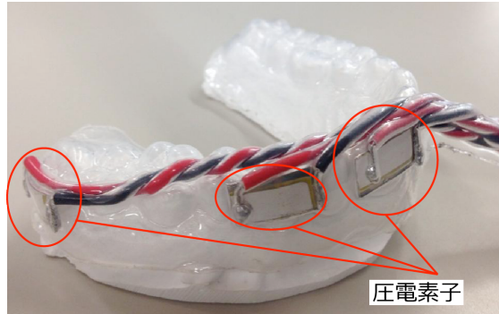
図1 マウスピース型歯骨伝導デバイス
