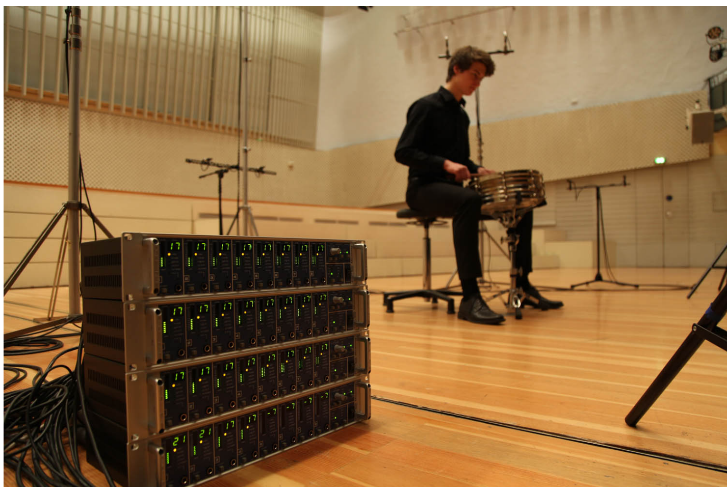
実際の録音で使用されているマイクヘッドアンプとADコンバーターであるRME Micstasyを使用
